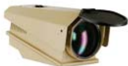
HRC-S: Объектив 39...490 мм, горизонтальное поле зрения 14,1°...1,1°.
