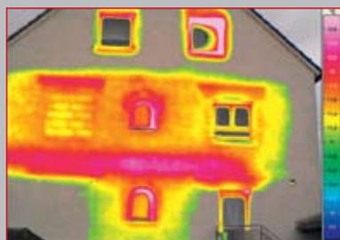
Режим совмещения изображений позволяет совмещать цифровую фотографию объекта с термографическим изображением этого объекта. Таким образом, упрощается распознавание деталей объекта на термографическом снимке.
